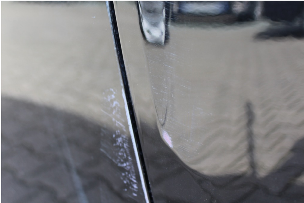
Bild 17 - Erneuerungsbedürftig (weitere Schadenstelle) - Seitenteil Teilersatz 1
