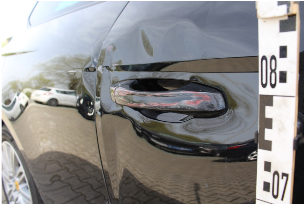
Bild 13 - Erneuerungsbedürftig - Türgriff aussen rechts
