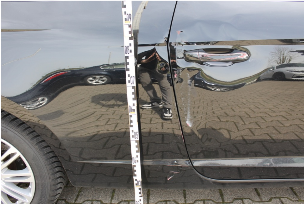
Bild 9 - Erneuerungsbedürftig - Tür v.
