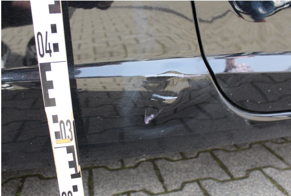
Bild 15 - Erneuerungsbedürftig - Seitenteil Teilersatz 1
